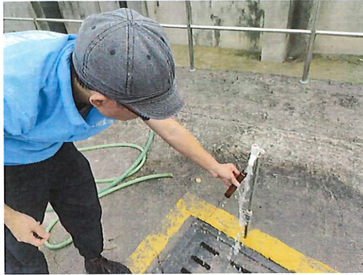
第二水厂出厂水采样口
